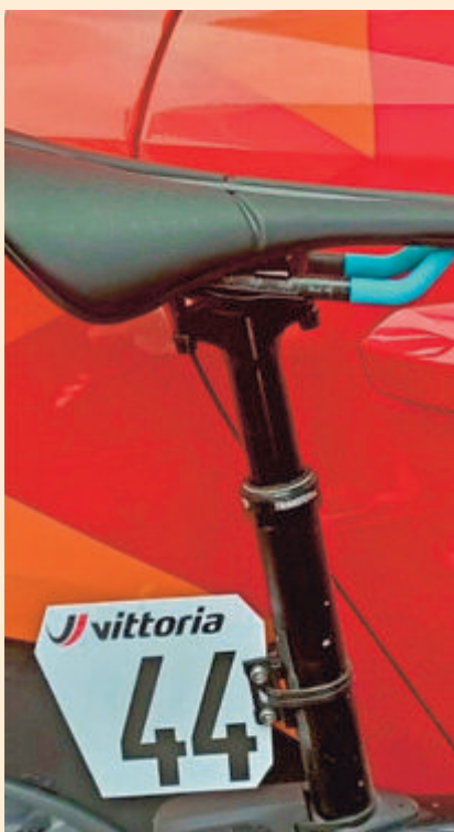
Matej Mohoric maakte gebruik van een dropper post (inschuifbare zadelpen) in Milaan-Sanremo, een technologisch snuffje uit het mountainbiken. © PHOTO NEWS/RV
